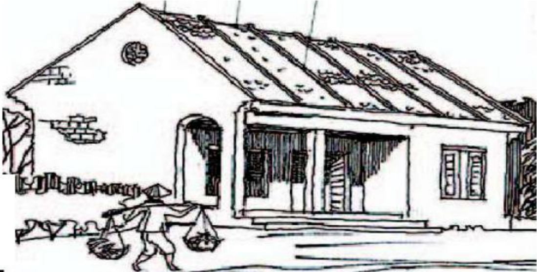
Hình 5. Giảm thiểu tốc mái ngói bằng chèn vữa
